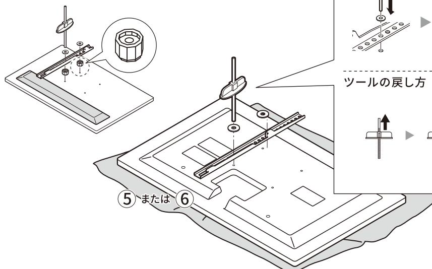
ネジのかわりにネジ穴計測ツールを入れて、
